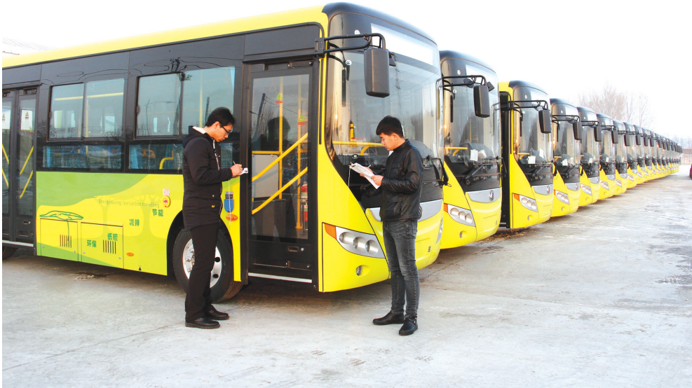
20辆纯电动公交车“宇通E8”落户镇赉,将于近日投入运营,镇赉县由此成为全市第一个拥有绿色环保公交车的县城。这批纯电动公交车,每辆价值70万元,车身长8米,定员60人,每充电一次可行驶150千米。镇赉县政府投资1000万元,为这批“绿色公交”建设了停车场、充电桩等附属设施。图为镇赉县客运公司工作人员正在做车辆登记。
