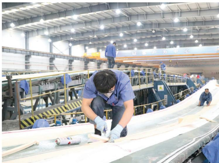
中材科技(白城)风电叶片有限公司位于白城工业园区,该公司成立于2010年4月,总资产2.39亿元,主要生产大型风电叶片,年设计产能500套。图为工作人员为68.6米长的风叶铺装玻璃纤维布。 本报记者李晓明 刘冠男摄
