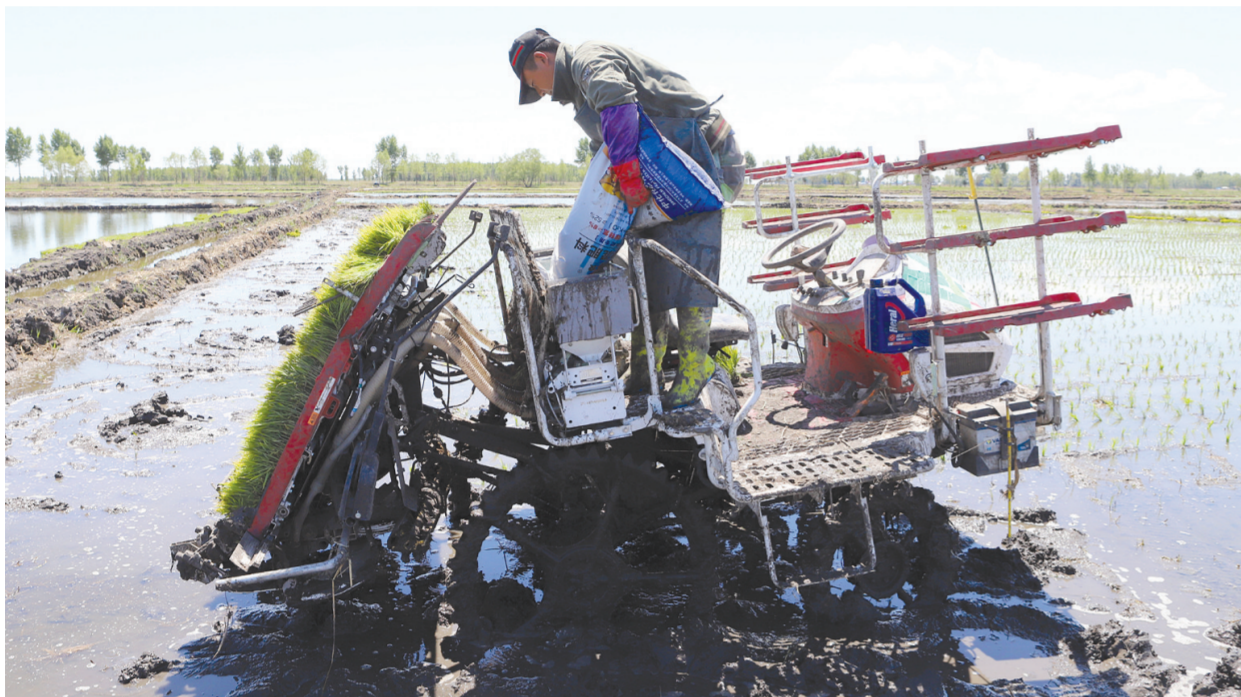
水稻机插秧同步侧深施肥技术在镇赉县大屯镇实施。
