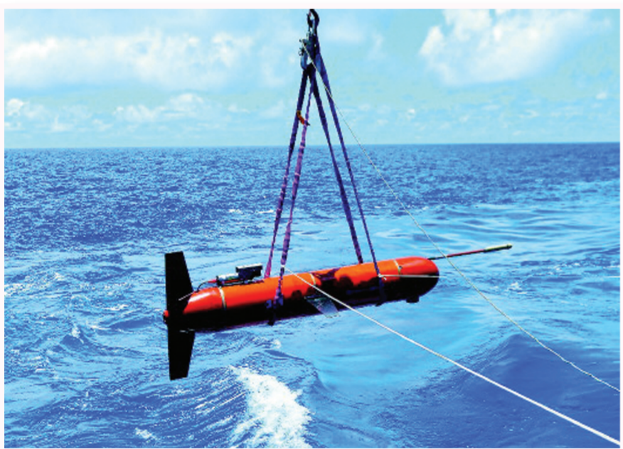
科考队员在布放“海翼”系列水下潜航器(资料照片)。
