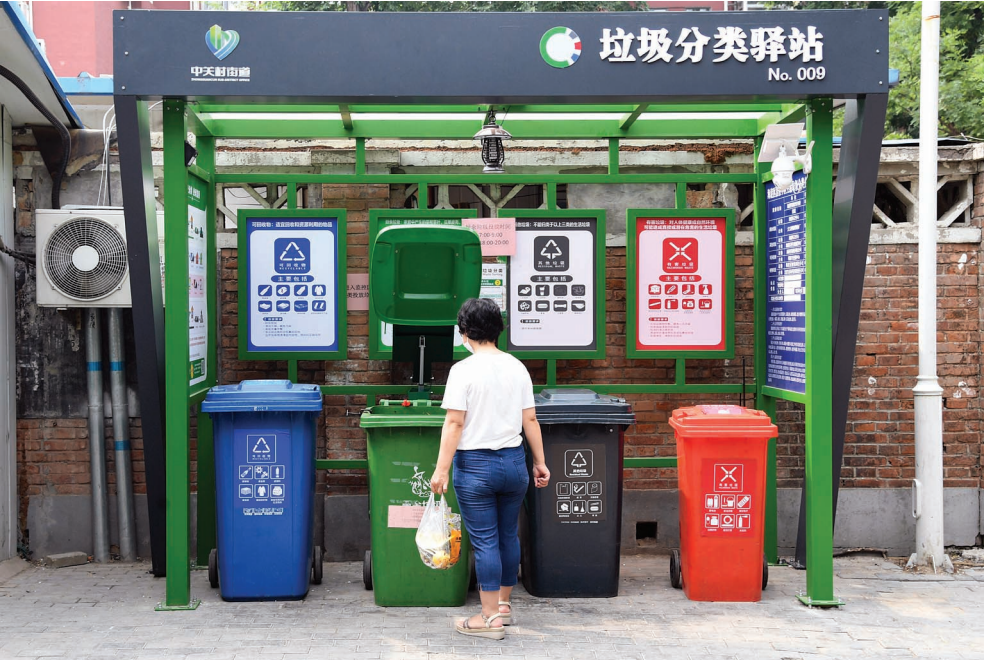
6月11日，在海淀区中关村街道东南社区，社区居民准备将厨余垃圾投入智能红外感应厨余垃圾桶。近日，北京市海淀区中关村街道设计的智能垃圾分类驿站在东南社区投入使用。据了解，该驿站集厨余垃圾智能开合、语音播报分类提示、诱捕蚊蝇夜间照明、人脸识别录像等功能于一体。居民在投放厨余垃圾时，触发垃圾桶底部的红外感应装置，桶盖自动打开，投放完毕后桶盖自动缓降复位，实现厨余垃圾无接触式投放。
