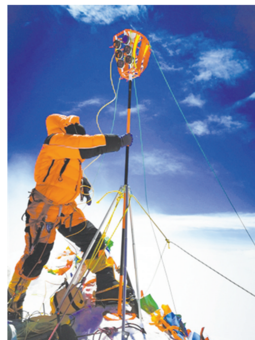
2020珠峰高程测量队员在峰顶竖起测量觇标 新华社特约记者 扎西次仁摄
