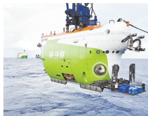
“奋斗者”号全海深载人潜水器 新华社发(中国船舶集团供图)
