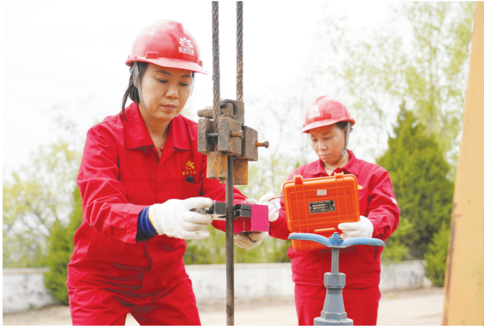
4月26日，女子采油站站刘小莉（左）和女工杨伟在抽油机旁进行功图测量工作。延长石油南泥湾采油厂新寨采油队女子采油站成立于2008年，这支驻扎在陕西延安南泥湾的队伍现有女工17人，管辖着107个井场的270口油水井，平均日产原油49.3吨。她们继承着自力更生、艰苦奋斗的精神，长期在野外工作环境中埋头苦干，用自己的青春和行动，在黄土高原上留下“石油之花”的别样风采。 新华社记者邵瑞摄
