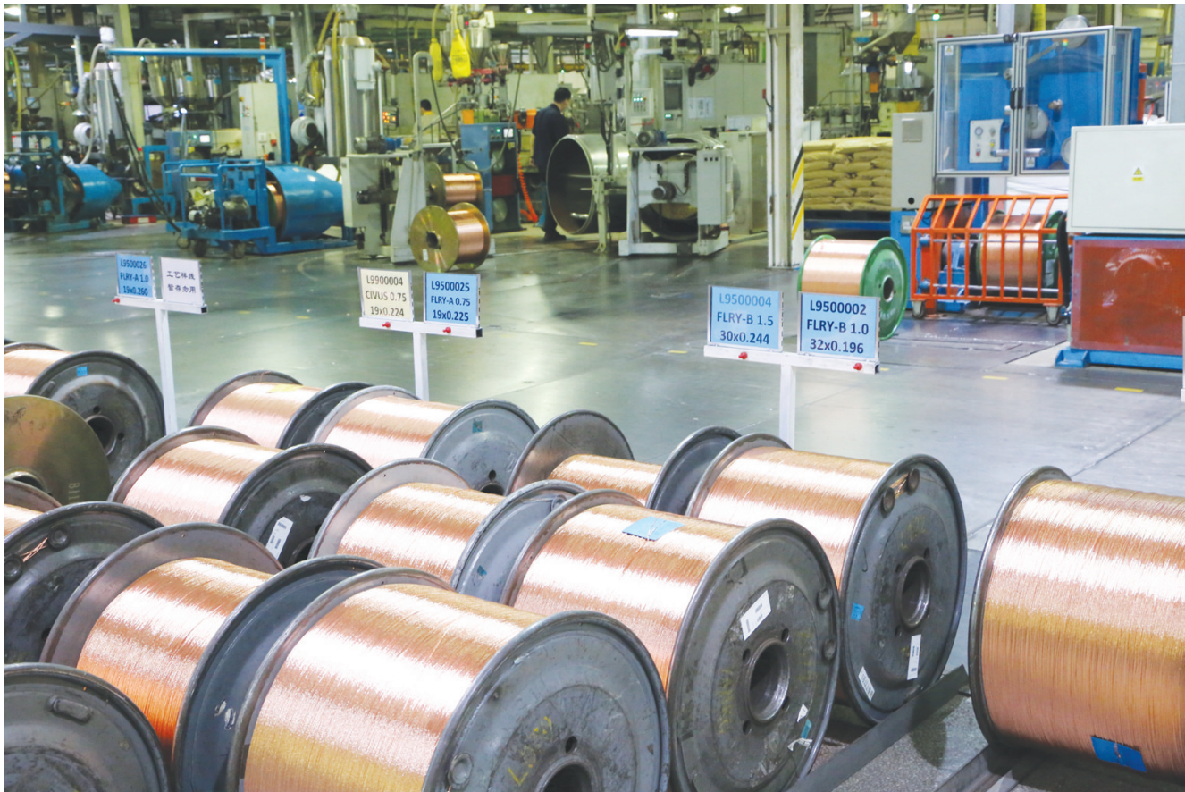
5月27日，安波福电气系统有限公司白城分公司汽车导线车间工人正在紧张的工作中。据了解，该公司生产的汽车导线主要用于汽车电信号传导，企业复工复产后，每周可生产汽车导线7万公里。本报记者王野村摄
