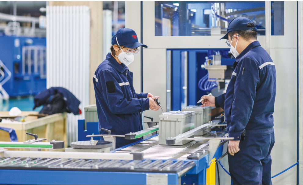
白城绿电产业示范园区,吉电能谷(白城)储能投资有限公司的员工在对铅炭电池进行气密性检测。 本报记者李晓明摄
