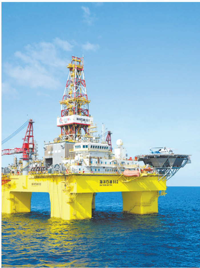
“海洋石油982”半潜式钻井平台是我国自主投资建造的第六代深水半潜式钻井平台,最大钻井深度9144米。
