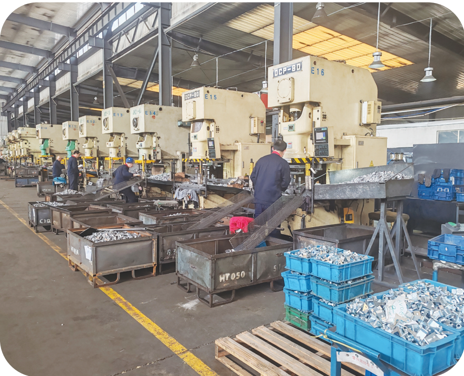
图为工人为汽车门铰链冲孔。
